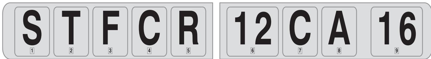
**1** Art der Schneidplattenbefestigung / Type of insert mounting
