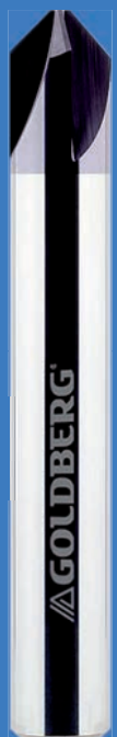
FM32 4-Schneidig (90° Fasenfräser) Fräsdurchmesser: 6,0 - 12,0 mm Beschichtung: TiAlN Anzahl der Zähne: 4 Typ: DIN 6535 HA Steigung: 0°
